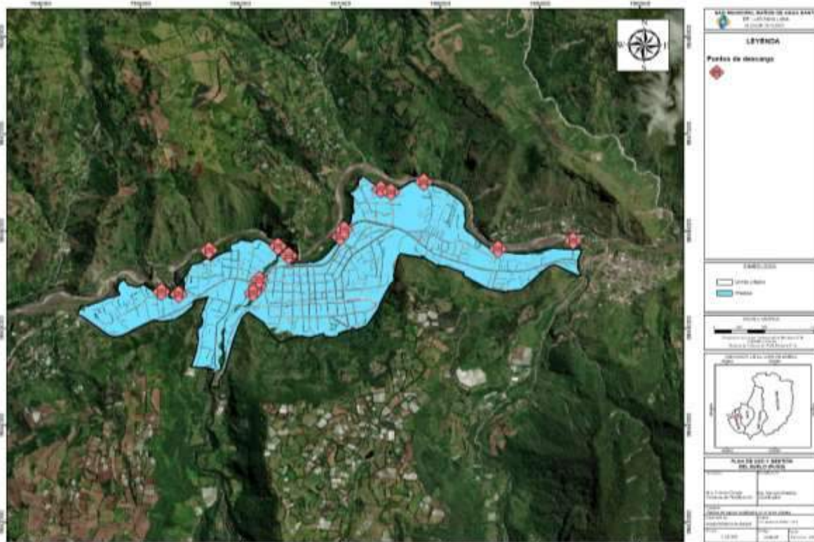
Ilustración 16. Puntos de descarga de aguas negras
